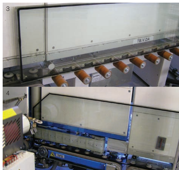
Bild 3: Scheibe mit TPS-Strang vor dem Zusammenbau
